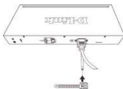
Рисунок 2-3. Установка зажима на стяжку
