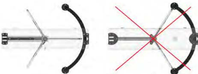
Правильно установленный ротор
