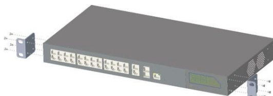
Рис. 2-1. Схема крепления кронштейнов.
